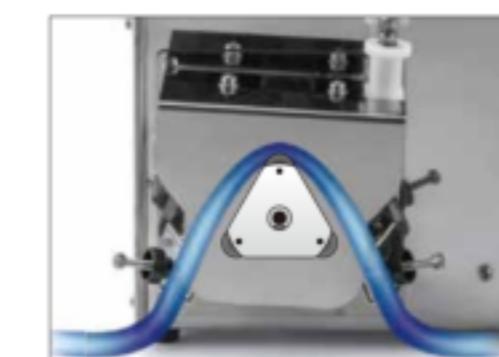
充填物は機械の中を通らず、チューブの中だけを通る仕組みなので、チューブを替えるだけで、すぐにアイテム交換ができます。
